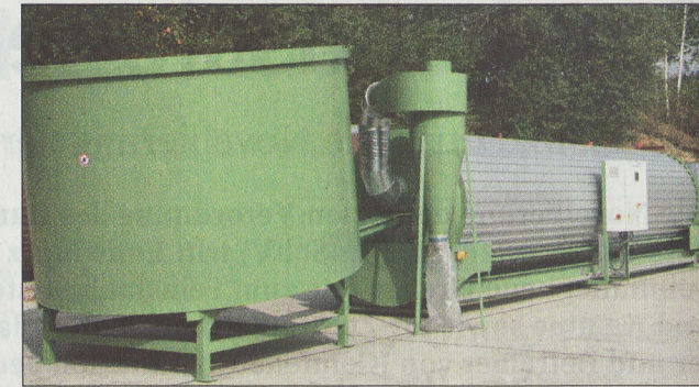
Die Versuchs- und Demonstrationsanlage bei Eberl trocknet mit 1 m 3 Hackschnitzeln durchschnittlich 6 bis 7 m 3 .
