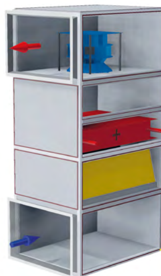
Stehende Kirchenheizung mit EC-Ventilator als Freiläufer
