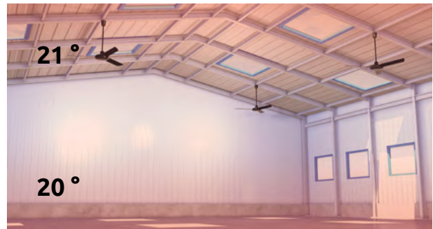
Wärmeverteilung mit Wärmerückführung
